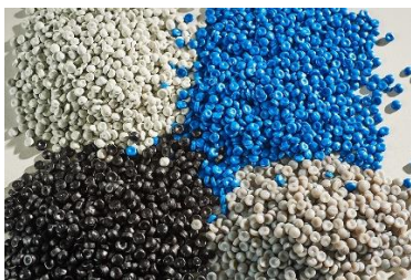
Mit «Bring Plastic back» wird der Haushalt-Kunststoff recycelt und zu Regranulat verarbeitet.
